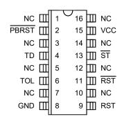
DS1232S 16-Pin SOIC (300-mil) See Mech. Drawings Section
